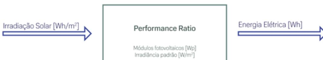
Figura 1: Representação do Performance Ratio de uma usina fotovoltaica
