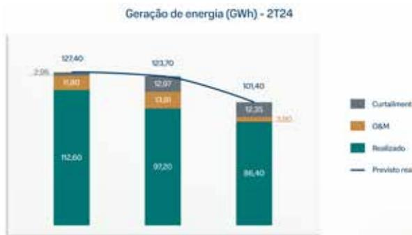
As perdas por operação e manutenção (O&M) devem ser estratificadas de acordo com a família de equipamentos (por exemplo, inversores, strings, trackers, transformadores) e por disciplina (elétrica, automação, civil, operação). Essa abordagem permite uma análise detalhada, alimentando as rotinas de confiabilidade para a tratativa e resolução dos problemas.
