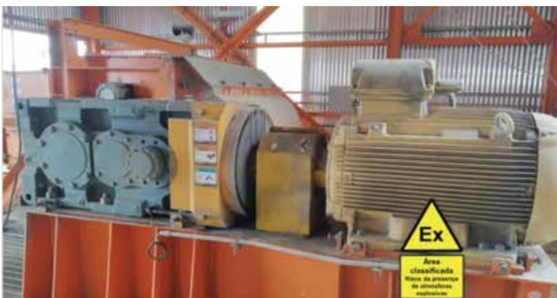
**Exemplo de instalação de conjunto motor + acoplamento + caixa de engrenagens, contendo equipamentos elétricos e mecânicos "Ex" em áreas classificadas, contendo a presença de atmosferas explosivas formadas por gases inflamáveis ou poeiras combustíveis**
