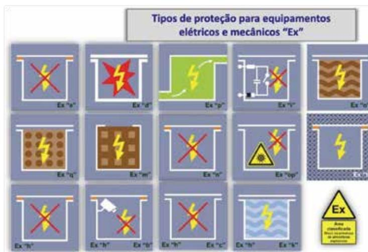
**Exemplos de tipos de proteção “Ex” aplicáveis para a certificação de equipamentos de instrumentação, automação, telecomunicações, elétricos ou mecânicos “Ex”, para instalação em áreas classificadas contendo a presença de atmosferas explosivas formadas por gases inflamáveis ou poeiras combustíveis**
