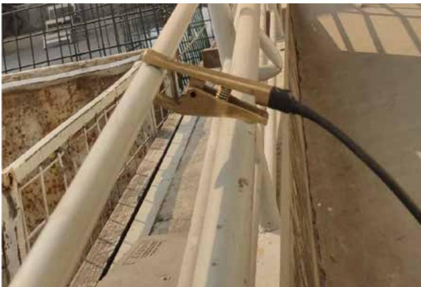
**Figura 5 – Medição de continuidade elétrica em guarda-corpo**
